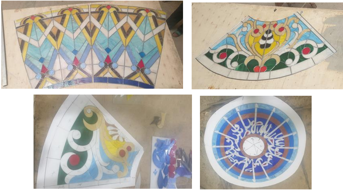
شكل ( ٢٧ ) يوضح عملية تقطيع وتعشيق زجاج القبة وفقاً للتصميم المقترح
