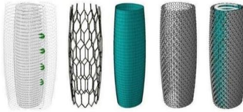
الشكل (١٢) يوضح شكل الطبقات الهيكلية للأبراج، من اليمين شكل المبني بالكامل ثم شكل وحدات المشربية المتحركة ثم الحائط الزجاجي ثم الأعمدة الصلبة المحيطة ثم الهيكل الخرساني.
