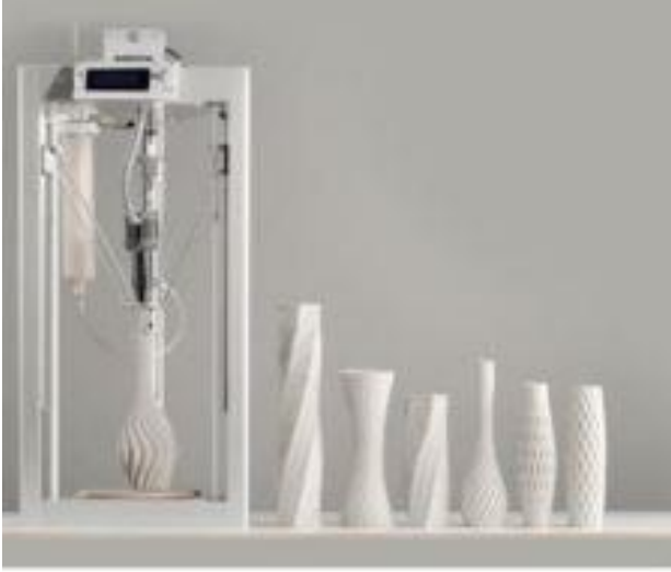
صوره رقم (12) يوضح مادة السيراميك اثناء الطباعة ونماذج بعد الطباعة.
