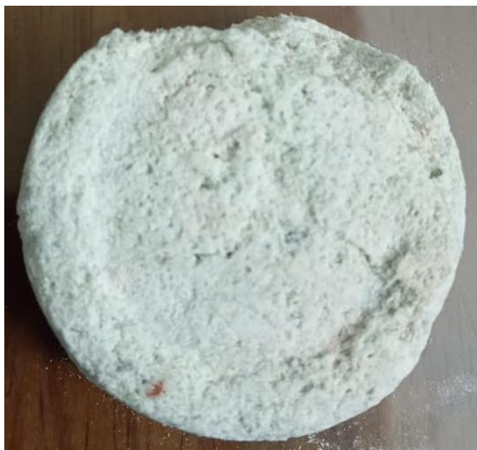
الشكل التوضيحي 12 يوضح شكل العينة الأولى بعد تعرضها لدرجات حرارة أعلى تصل إلى 750 °م
