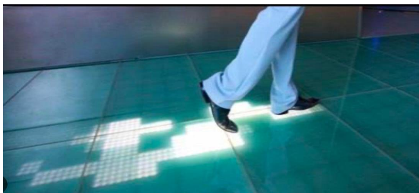
صور (١٨)(١٩)(٢٠) توضح الأرضيات التفاعلية فكرة التفاعل من خلال التماس وهو يعمل بواسطة جهاز الإدخال الخفيف مع أضواء التفاعل من خلال التماس Light input Device x
