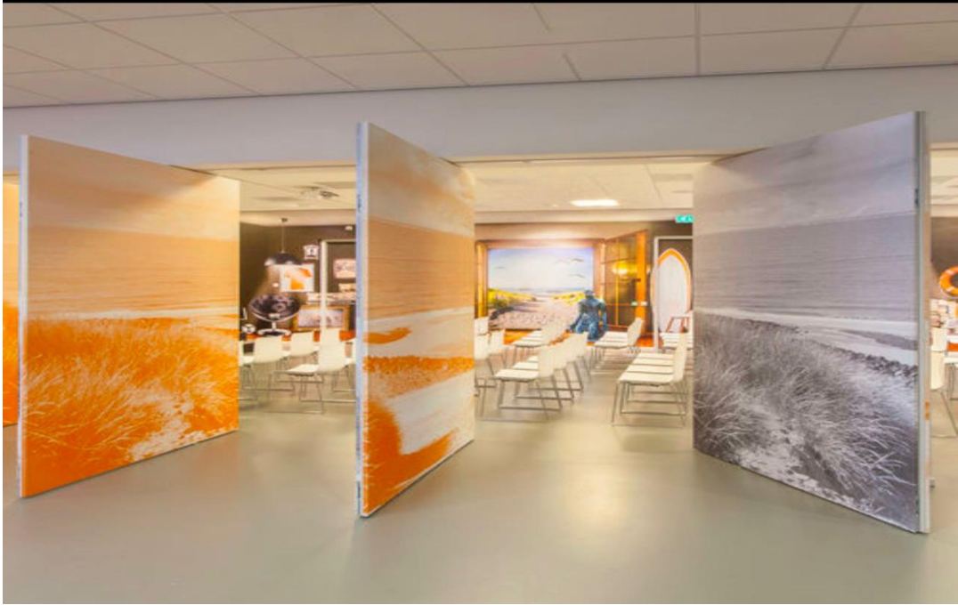
صورة رقم (١٥) توضح قواطع متحركة ذات حركة محورية تدور حول محور ثابت في السقف أو الأرض مما يتيح لها الانتقال بين وضع الإغلاق والفتح بزاوية دوران تصل إلى ٣٦٠ دون الحاجة إلى نظام قضبان.
